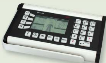
Terminal kierowcy z klawiaturą silikonową montowaną w produkcji seryjnej
